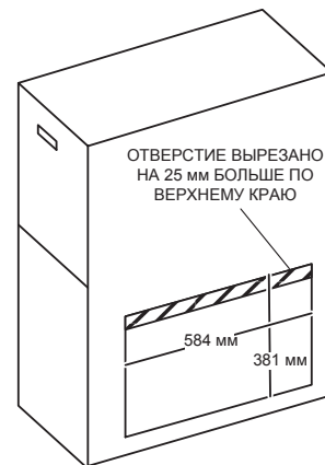
ВОЗДУХОНАГРЕВАТЕЛЬ С НАПРАВЛЕНИЕМ ПОТОКА ВОЗДУХА ВВЕРХ (Вариант 2 – Обратн. Воздуховод Сбоку – 17,6 кВт) (Отверстие в Обратном Воздуховоде Переделано)
